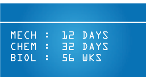
График обслуживания Отображает информацию о необходимости обслуживания фильтра (замены картриджа)
